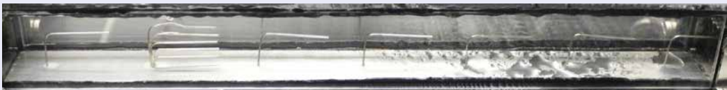
Kondensation bei Betrieb mit 6,6 Vol% Wasser im Gasstrom
