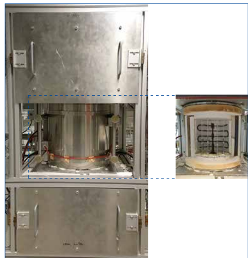
Versuchsstand mit geöffneter 8-Kanal-Reaktionszone für Katalysator tests
