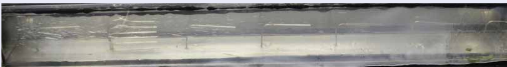
Kondensation bei Betrieb mit 6,6 Vol% Wasser und 2 ppm Schwefelsäure im Gasstrom
