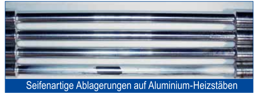
Seifenartige Ablagerungen auf Aluminium-Heizstäben
